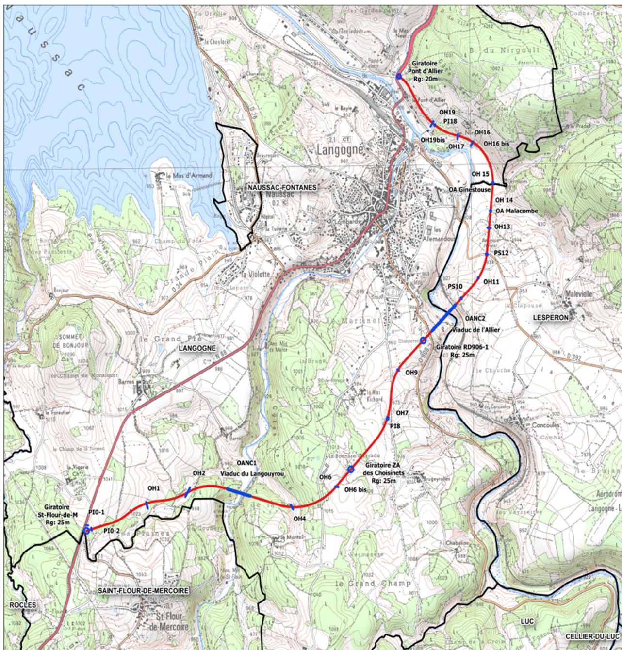
Figure 2 : Schéma de principe du contournement de Langogne et ses ouvrages hydrauliques (source : dossier).
